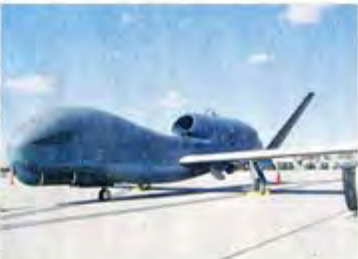
グローバルホーク 主翼幅約40m、全長約14.5mの大型無人偵察機。高性能カメラや赤外線センサーなど高感度の通信傍受機能を備え、夜間や悪天候下でも目標の捕捉が可能だ。約5600キロ。先まで見通す偵察能力を持つ。攻撃能力は装備されていない。気象観測や災害状況を把握する目的でも活用されている。
